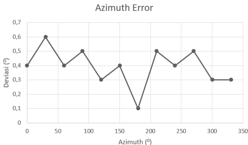
Gambar 17. Deviasi Azimuth antara pengaturan IFR 4000 dan pembacaan Penerima VOR.
