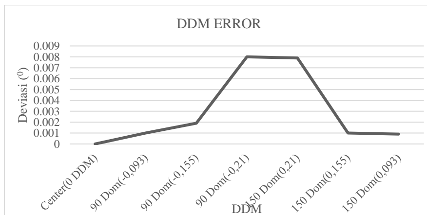
Gambar 18. Deviasi DDM antara pengaturan IFR 4000 dan pembacaan penerima Localizer .
