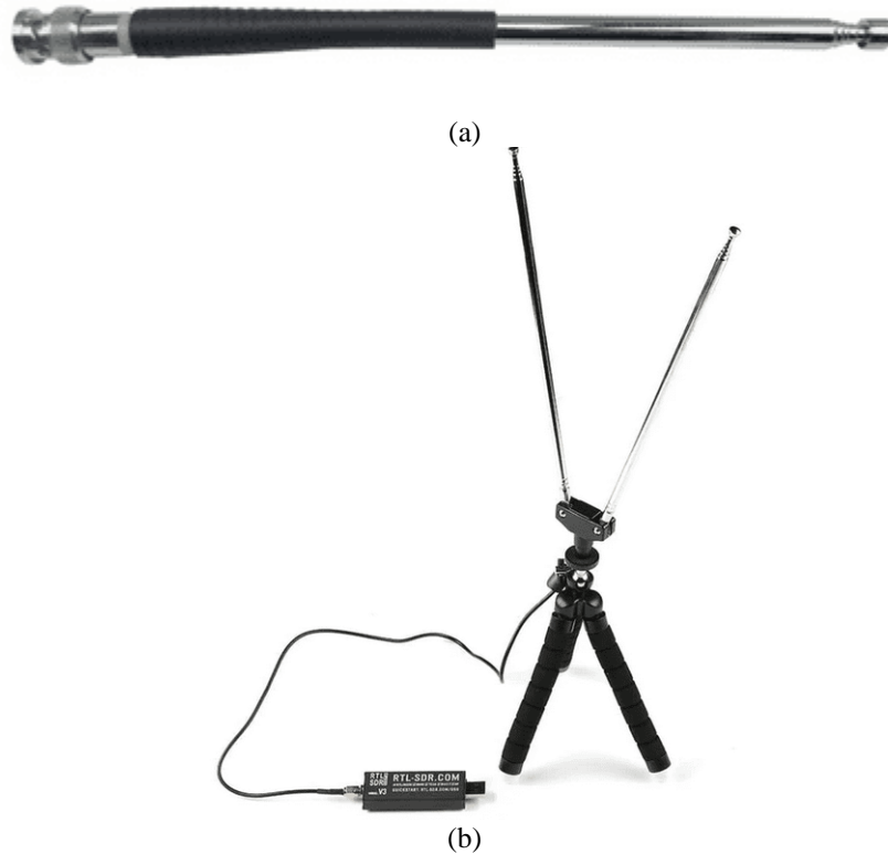
Gambar 15. Antena untuk keperluan pengujian, (a)Antena omni directional IFR 4000, (b) Antena dipol RTL-SDR.
