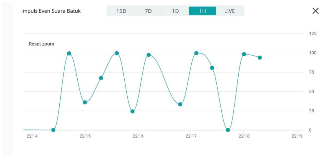
Gambar 9. Hasil deteksi suara batuk tanpa jeda dalam persen confidence level .
