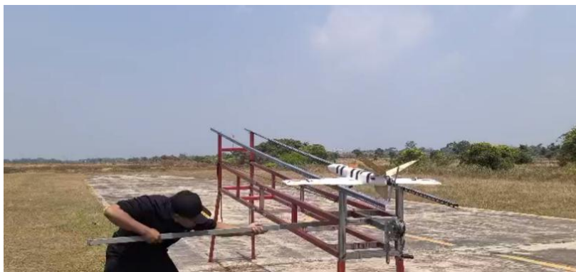
Gambar 9. Pengujian pengaruh panjang catapult pada UAV Talon Y-Tail .
