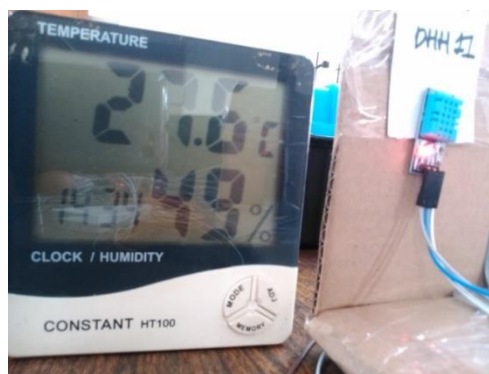
Gambar 9. Pengukuran Suhu dan Kelembapan DHT11 dan Constant HT100
