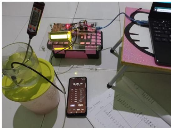
Gambar 9. Proses kalibrasi sensor DS18B20.
