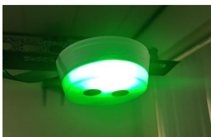
Gambar 10. Sensor ultrasonik dan lampu indikator.
