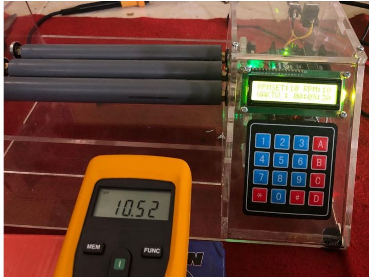
Gambar 4. Pengujian kecepatan putar pada blood roller mixer dengan tachometer .
