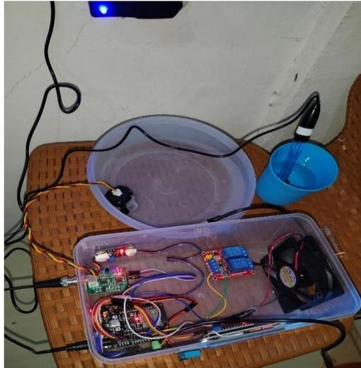
Gambar 13. Implementasi seluruh sensor pada sumber air
