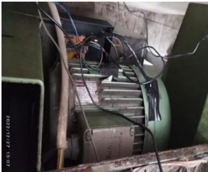
Gambar 4. Motor 3 fasa pada mesin bubut.
