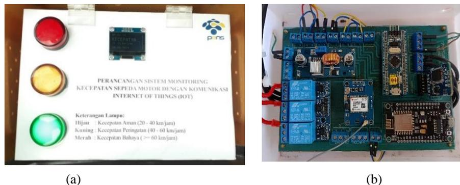
Gambar 2. *Hardware*: (a) tampak depan; (b) tampak dalam.
