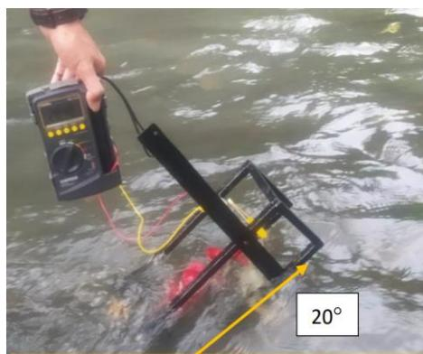
Gambar 4. Pengujian dengan kemiringan  $20^{\circ}$ .
