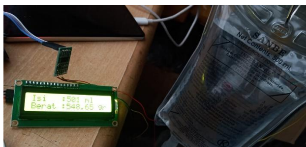
Gambar 14. Proses pengujian sensor loadcell dengan volume kantung infus
