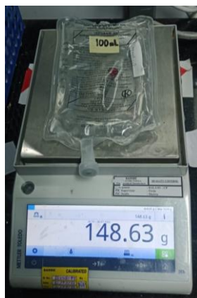
Gambar 13. Proses penimbangan kantung infus.
