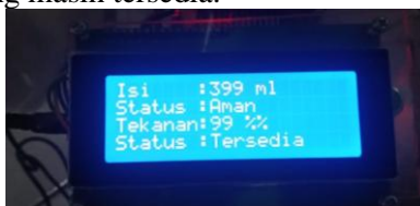
Gambar 16. Pengujian fungsi warning system pada LCD.
