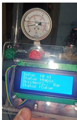
Gambar 15. Proses pengujian sensor pressure dengan pressure gauge .
