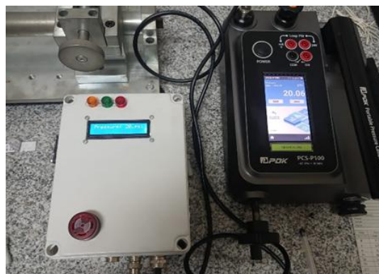
Gambar 5. Proses Kalibrasi alat dengan alat standar kalibrasi tekanan.
