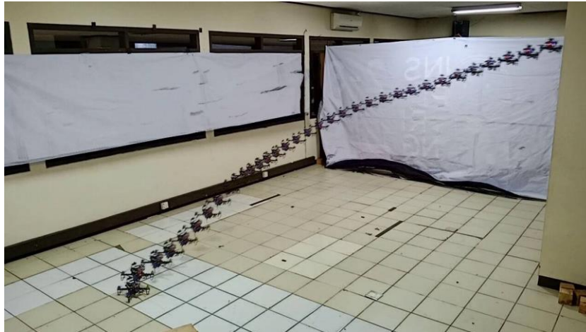
Gambar 7. Pergerakan Quadcopter dengan ketinggian maksimum 2,14 m.
